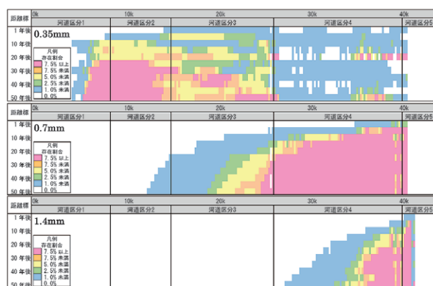
図-9 置き土粒径の違いによる移動状況の比較
