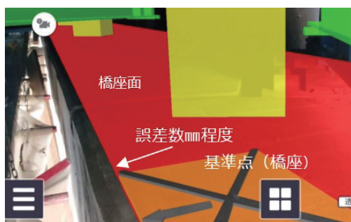
図-15 下部工(橋座面)に対する位置合わせ
