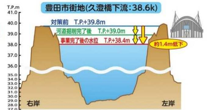
対策による水位低下効果(横断面図)
