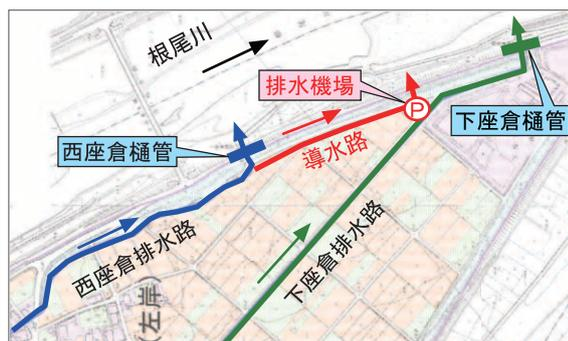
図-4 導水路及び排水機場の設置位置
