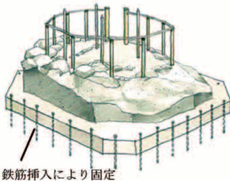
鉄筋挿入により固定
