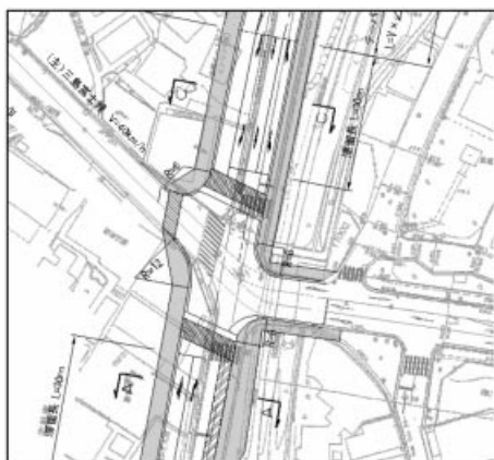
図-4 南北方向の対策案(付加車線の設置)
