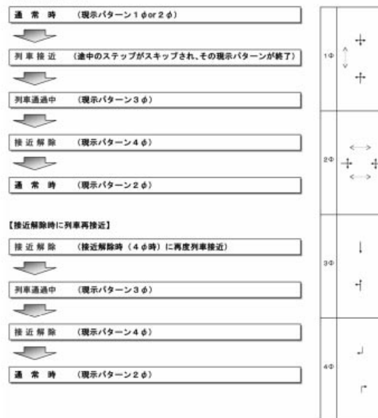
図-3 踏切遮断時の信号現示
