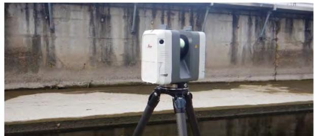
図-4 使用機器（Leica RTC360）
