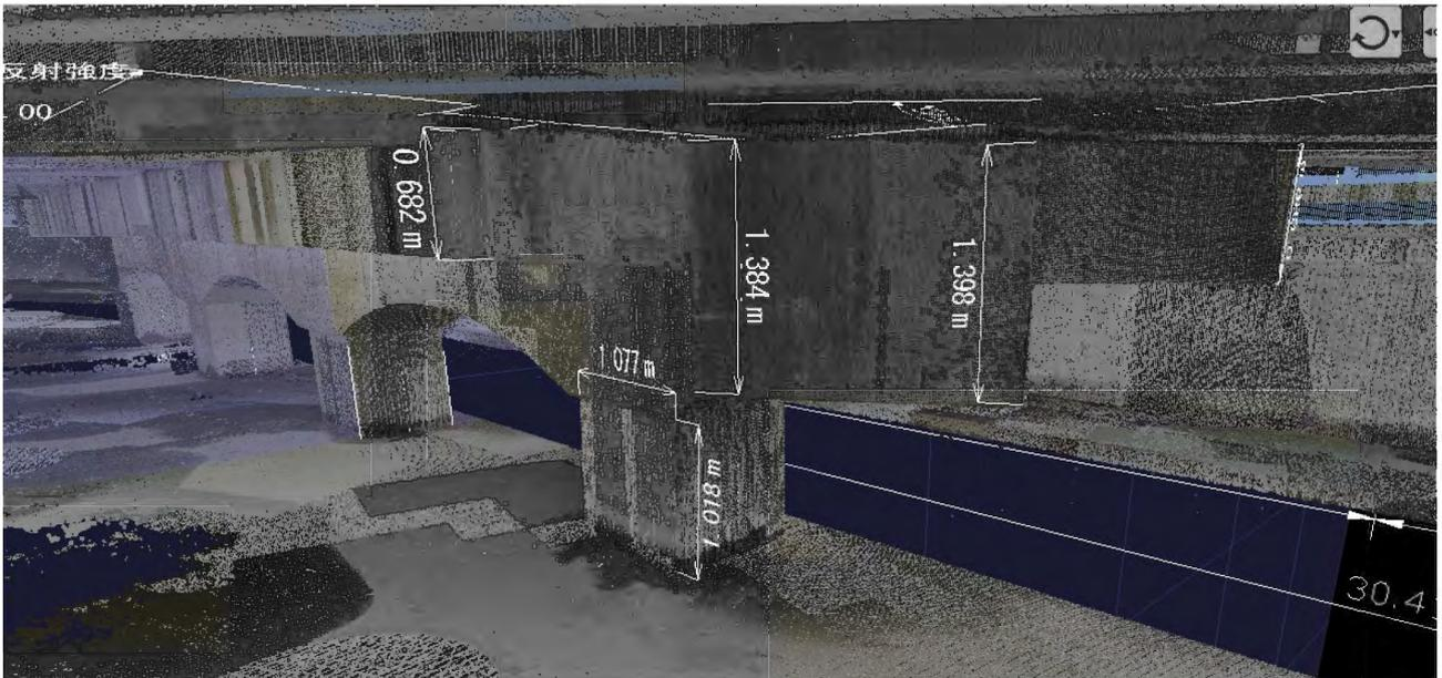
図-8 取得点群データを活用した構造寸法計測
