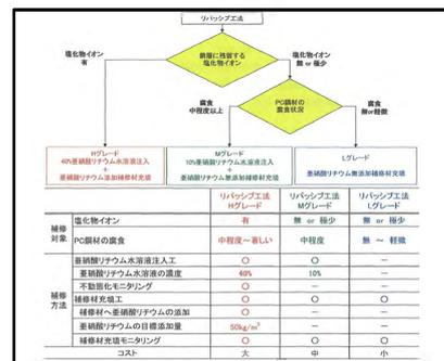
図-9 グラウト再注入工法 (リパッシュ工法) 1)
