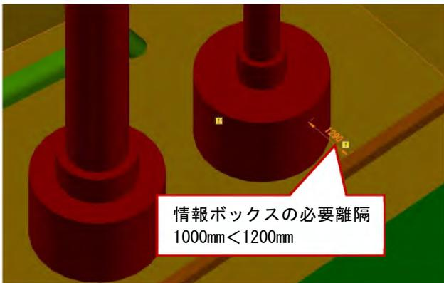
図-10 情報ボックスと基礎工 (P4) の離隔
