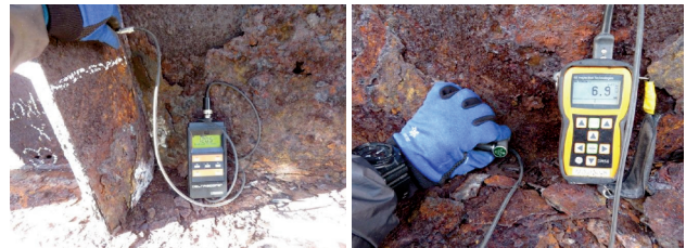
写真-3 計測状況、(左)電磁膜厚計によるさび層厚さ計測、(右)超音波計測器による板厚計測
