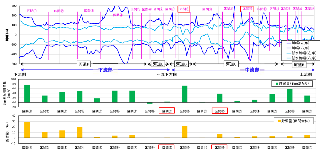
図-10 縦断的な川幅と区間別河道貯留量の関係
