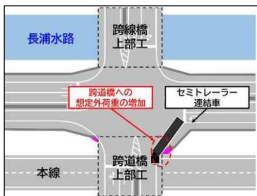
図-7 跨道橋への想定外荷重の増加
