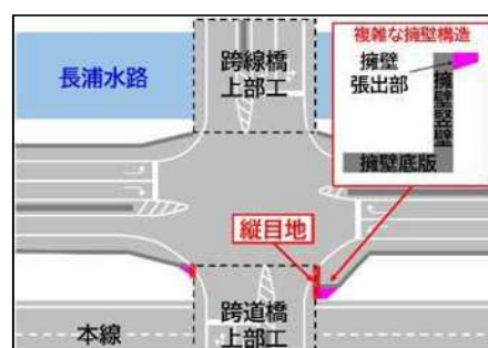
図-6 縦目地及び複雑な擁壁構造
