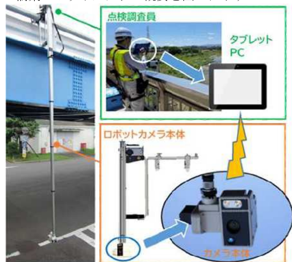
図-2 橋梁点検ロボットカメラ（新技術）
