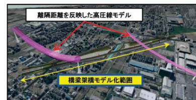
橋梁と架空線の離隔確認
