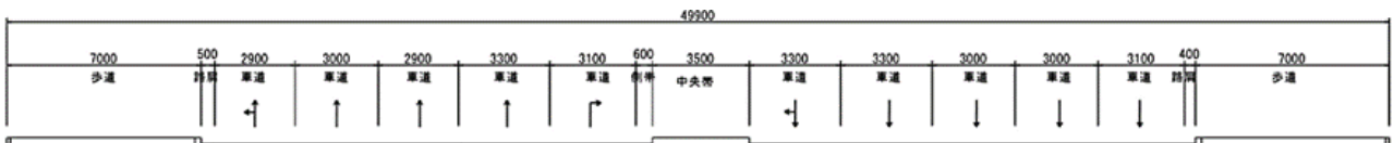
図-3 10車線区間における標準幅員構成
