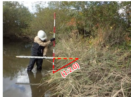
写真-5 セグメント2-2におけるタコノアシ生息環境の河岸勾配(令和3年11月撮影)
