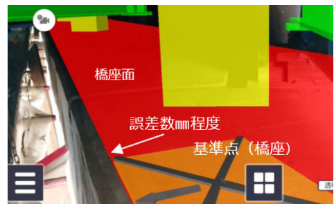
図-15 下部工 (橋座面) に対する位置合わせ
