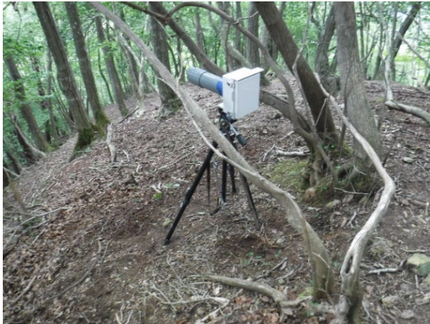
図-4 インターバルカメラの設置状況
