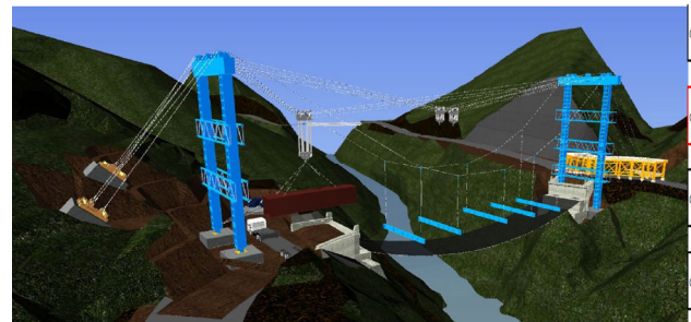
図-9 STEP9：桁架設
