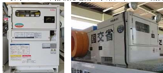
図-2 発電機（左：照明車搭載 右：排水ポンプ車搭載）
