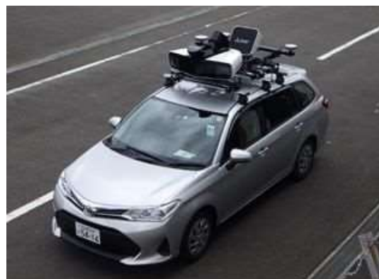
図-3 計測機器の概観（カラーフィールダーに装着したイメージ）
