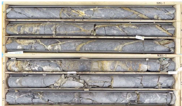
写真-2 ボーリングコアの緩み岩盤状況
