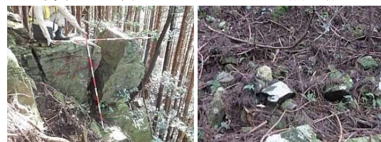
写真-2 斜面上に点在する不安定岩塊
