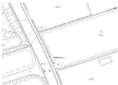
図-1 平板測量より作成した現況平面(2Dモデル)
