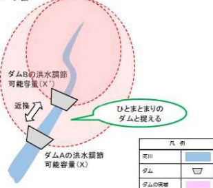
図-8 複数ダムがある場合の貯水位低下量算定方法
