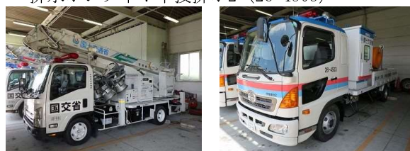
図-1 災害対策用機械（左：照明車 右：排水ポンプ車）
