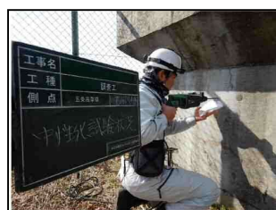
写真-4. 中性化に対する試験の実施
