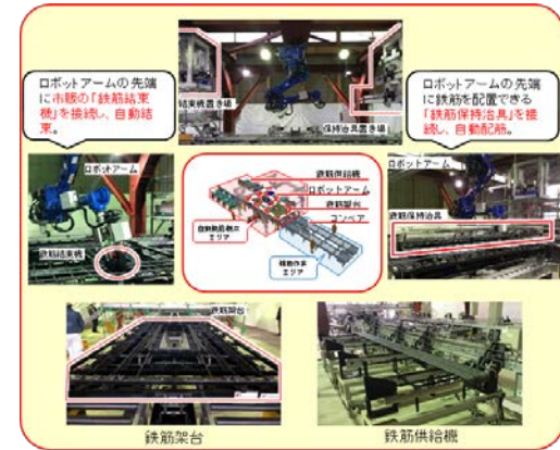
鉄筋組立自動化システム『ロボタラス』の開発【三井住友建設株式会社】
