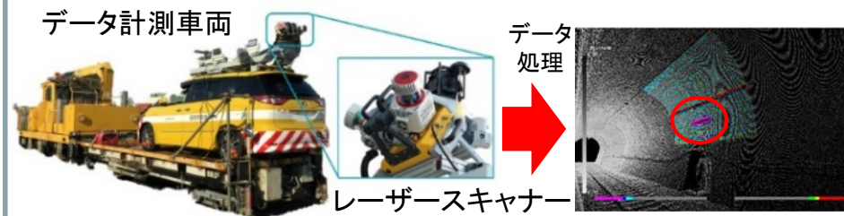
※道路用のデータ計測車両を鉄道台車に搭載し、けん引
