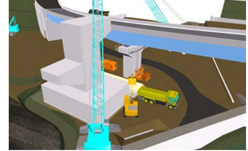
重機、仮設材の配置を事前に確認
