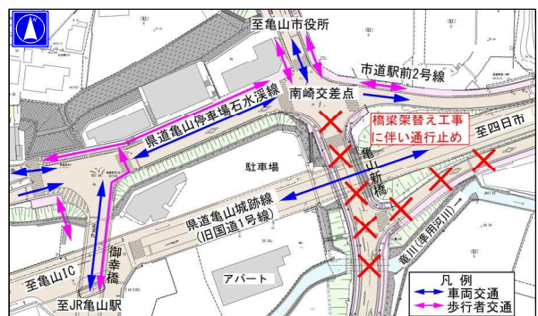
図-7 工事中の橋梁架替え地点の交通経路
