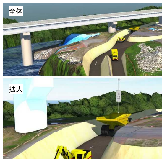
図10 橋脚と重機との干渉
