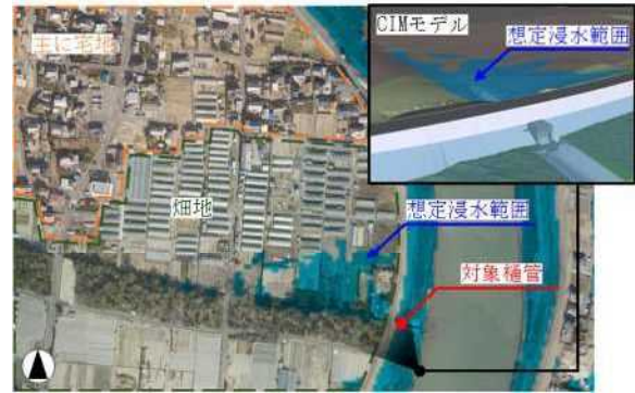
図-12 CIM モデルによる想定浸水範囲の可視化
