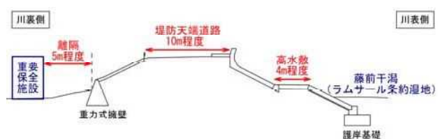
図-7 堤防横断形状と制約条件
