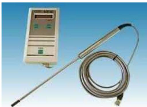
1次元電磁流速計(一方向, 点計測)
