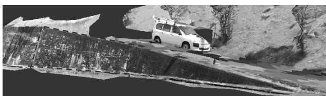
図-9 コンクリート擁壁の3Dモデル
