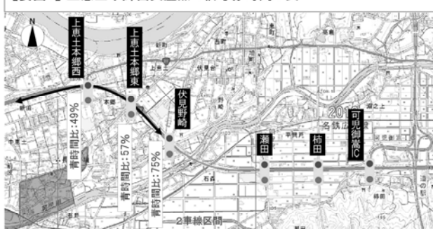
【要因2】交差道路からの合流交通が多い（片側1車線では滞留スペースが不足）
