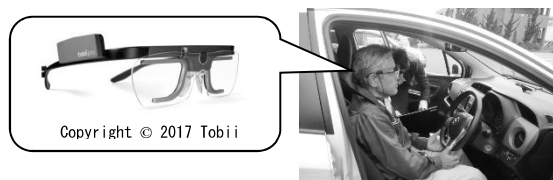
図-8 アイマークカメラと設置状況
