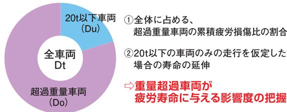
図8 重量超過車両の影響度検討のイメージ
