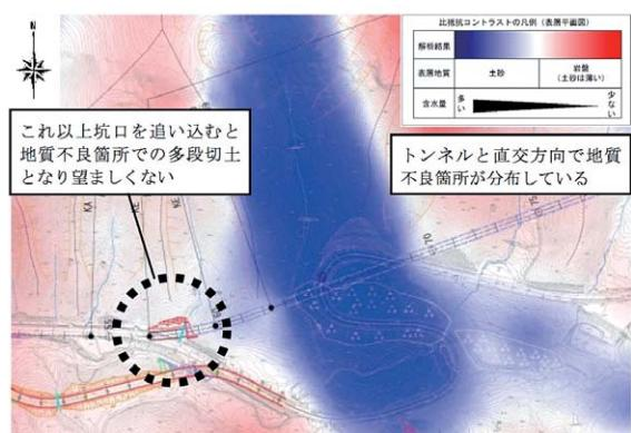
図-6 起点側坑口部 比抵抗平面図(コントラスト表示)
