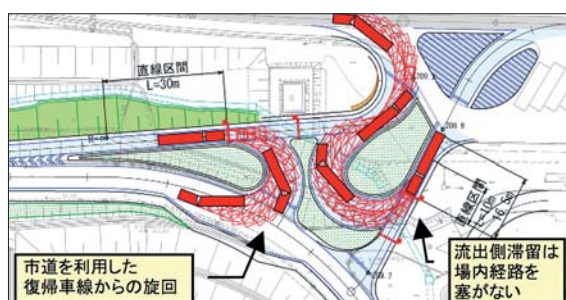
図-9 車両走行軌跡による復帰車線の走行確認
